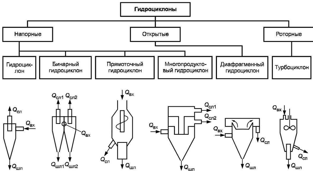
Рисунок 8 — Классификация гидроциклонов
