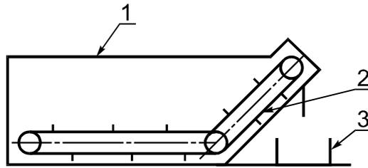
1 — резервуар; 2 — скребковый конвейер; 3 — тара для шлама
