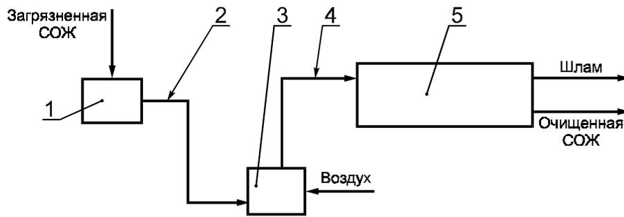
1 — бак; 2 — трубопровод; 3 — аэратор; 4 — эрлифтный трубопровод; 5 — флотатор
