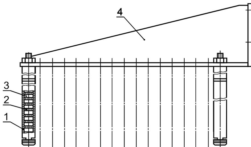
1 — латунная гильза; 2 — магнитопроводящие шайбы; 3 — магнитный элемент; 4 — траверса
