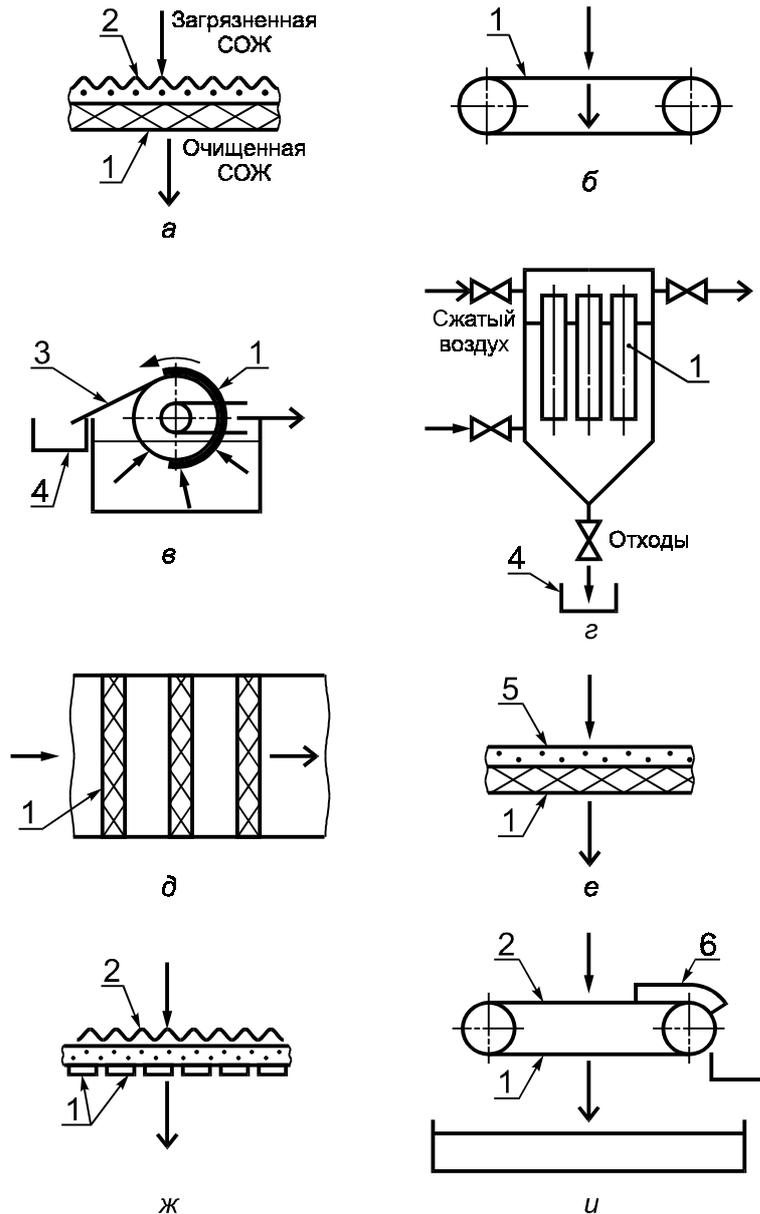
а — через фильтровальную перегородку; б — в ленточных фильтрах; в — в барабанных фильтрах; г — в патронных фильтрах; д — в кассетных фильтрах; е — в намывных фильтрах; ж — в щелевых фильтрах; и — в ленточных фильтрах
