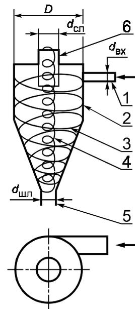
1 — тангенциальный патрубок; 2 — цилиндрическая часть гидроциклона; 3 — нисходящий поток; 4 — восходящий поток; 5 — шламное отверстие; 6 — сливной патрубок
